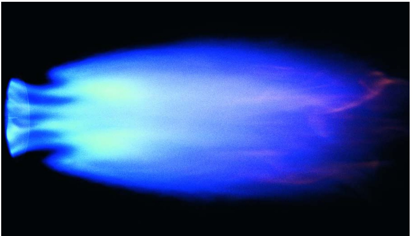
Tipica fiamma dei bruciatori in esecuzione LN (LowNO x )
